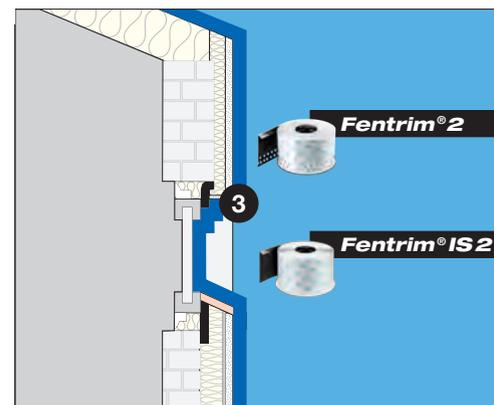
Niveau fonctionnel côté ③ extérieur : étanchéité
