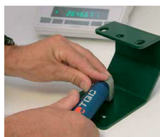
Mesure de résistance d'accroche de la laque par quadrillage
