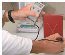
Mesure d'épaisseur de laque
