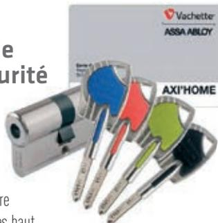
Ce cylindre de serrure de porte offre un très haut niveau de sécurité. Il permet une protection contre les effractions par crochetage de la goupille, par perçage du barillet ou par casse du cylindre. Clés triangulaires à reproduction possible uniquement avec la carte de propriété.
