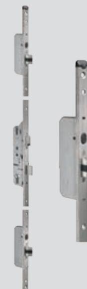
Serrure à verrouillage automatique 3 points. Lors de la fermeture de la porte, les deux pennes s'engagent automatiquement sur 20 mm. Avec fonction journalière et maintien de battant intégré.
