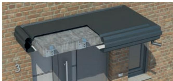
Au choix sous forme d'habillage (par exemple type KV 360). Dans ce cas de figure, la tôle murale est découpée à la dimension de la dalle en béton pour permettre l'enfilade de l'auvent sur cette dernière.
