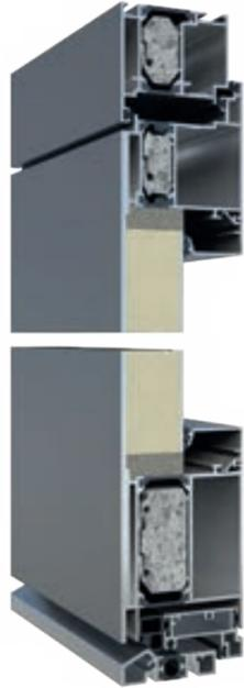
Le système KO 80 HD est notre profilé lé de base, disponible en ouverture intérieure et extérieure selon vos besoins. Le panneau peut être en feuillure, recouvrant l'ouvrant extérieur et recouvrant extérieur et intérieur. La mousse ISOPOR dans les profilé et les 3 joints d'isolation garantissent une bonne isolation thermique. Ce profilé lé peut aussi être cintré (arc et plein cintre).
